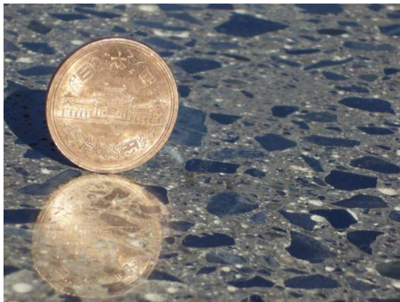
削り深さ 3 mm 研ぎ出し鏡面仕上げ
